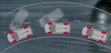
**Система активного контроля траектории**. Инновационная технология, обеспечивающая уверенную управляемость в поворотах. Она анализирует процесс поворота и может в случае необходимости подтормаживать каждое колесо по отдельности.
