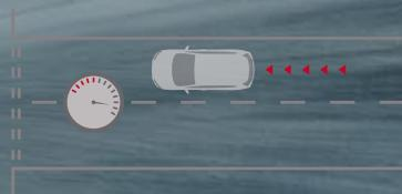
**Система активного торможения двигателем\***. При снижении скорости перед поворотом или остановкой система использует трансмиссию Xtronic® для торможения двигателем, как переключение на пониженную передачу в традиционных трансмиссиях — для плавного замедления и большего спокойствия при торможениях.
