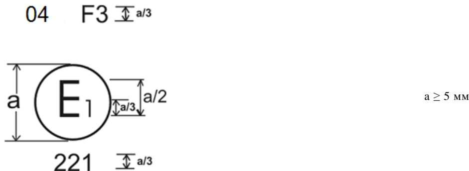
Рис. 7 Примеры схем знаков официального утверждения для передних противотуманных фар класса "F3"
