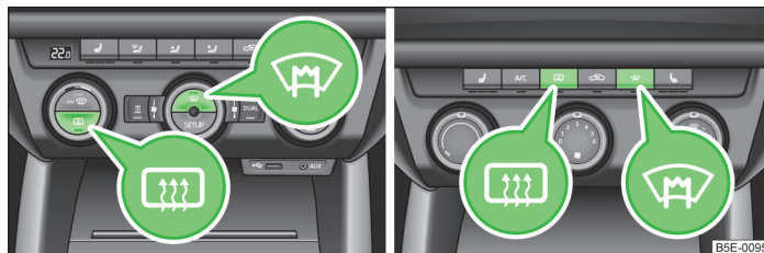
Илл. 35 Клавиши обогрева ветрового и заднего стёкол Climatronic/климатическая установка с ручным управлением, отопитель
