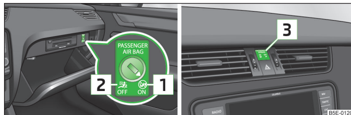
Илл. 137 Выключатель с замком для подушки безопасности переднего пассажира / контрольная лампа отключения/включения подушки безопасности переднего пассажира
