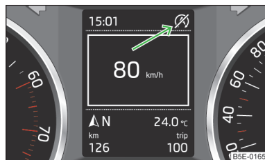
Илл. 114 Дисплей комбинации приборов: функция выключения двигателя в данный момент недоступна
